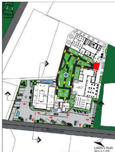
Gambar 6. 27 Aplikasi Sistem Eelektrikal Posisi Genset Sumber: Analisa Penulis, 2022
