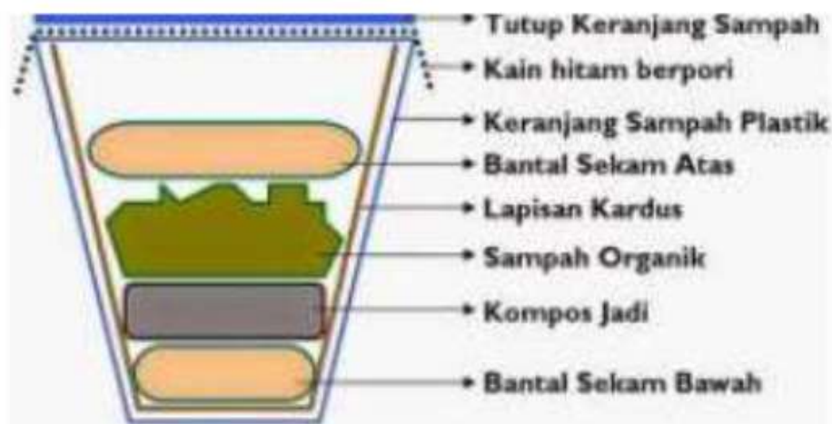
Gambar 3. Desain kompos dengan metode Takakura (Astuti dkk.; 2018)
