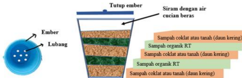
Gambar 1. Desain komposter sederhana untuk sampah organik rumah tangga (RT).
