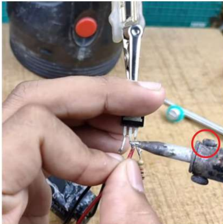
Gambar 31. Menyambung kutub (+) pompa
