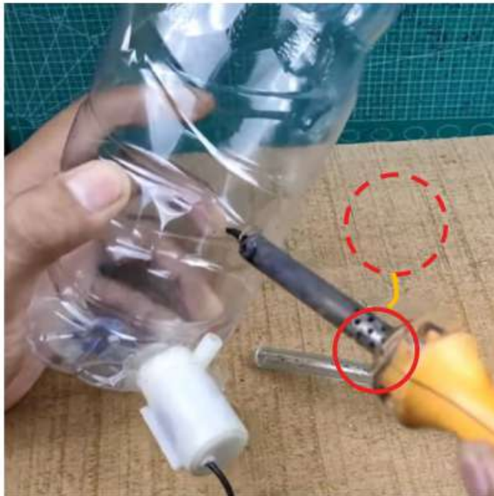
Gambar 24. Beri lubang lagi untuk selang air
