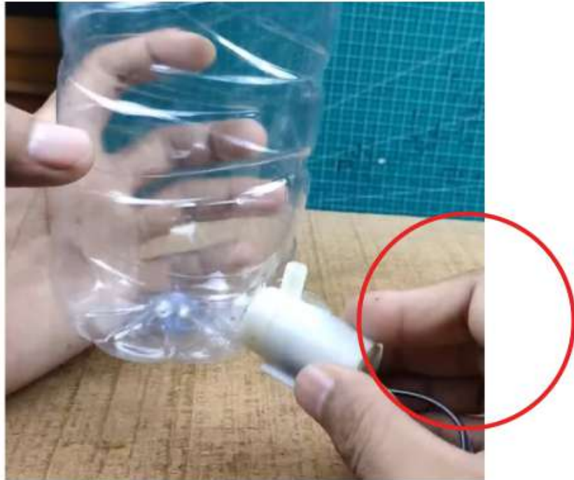
Gambar 23. Menempelkan mini pump pada bagian yang telah terlubang
