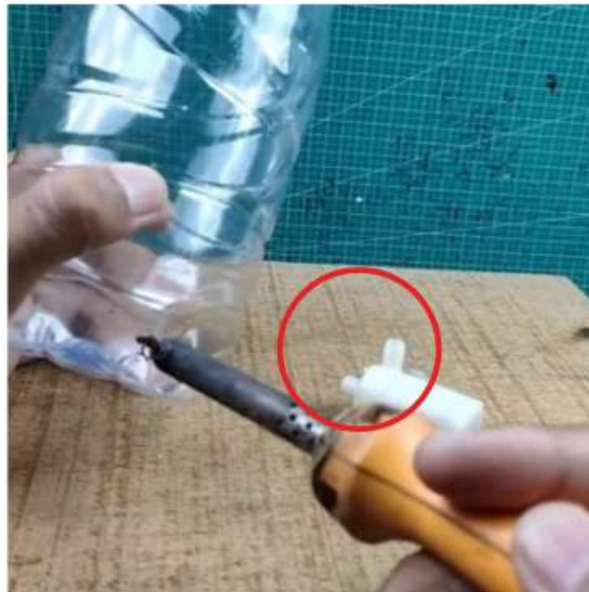
Gambar 22. Melubangi Botol untuk minipump 3v
