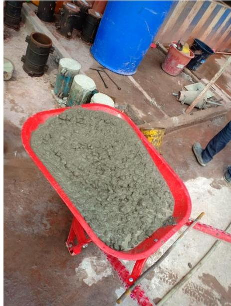
Gambar 2. 1 Campuran Beton dengan mutu K350
