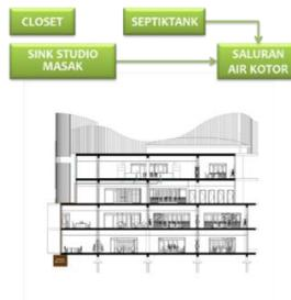
Gambar 6. 17 Aplikasi Sistem Pembuangan Air Kotor
