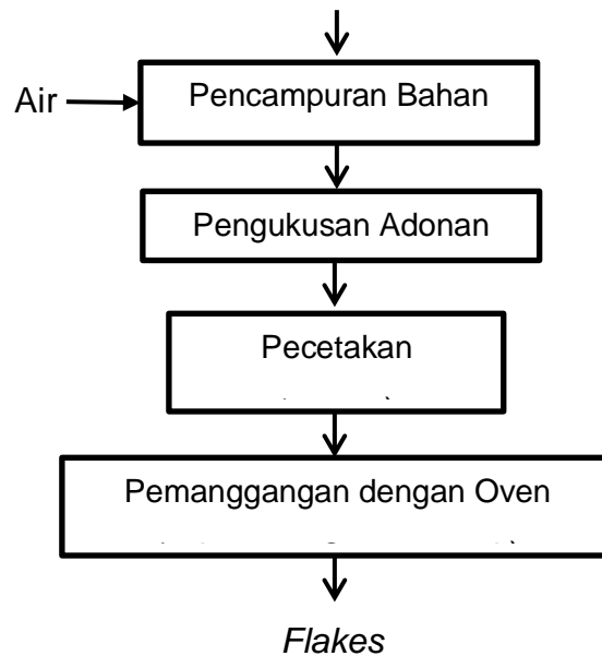
Gambar 1. Diagram Alir Proses Pembuatan Flakes (Febrianty dkk, 2015).
