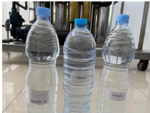
Gambar 23. Sampel A : sampel air dengan debit 7 lpm dan tekanan 12 bar
