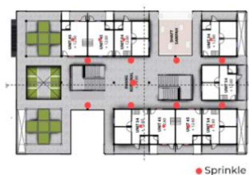
Gambar 6. 33. Aplikasi Sistem Sprinkle Pada Bangunan Rumah Susun.
