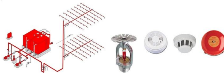
Gambar V.17 Sistem sprinkler dan alat alat pemadam
