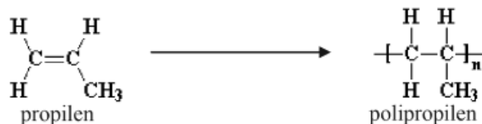
Gambar II. 1 Pembentukan Polypropylene dari Propylene
