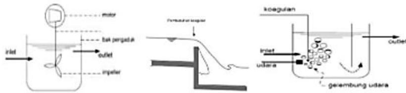
**Gambar 2.13** Pengadukan Mekanis, Pengadukan Hidraulis, dan Pengadukan Pneumatis
