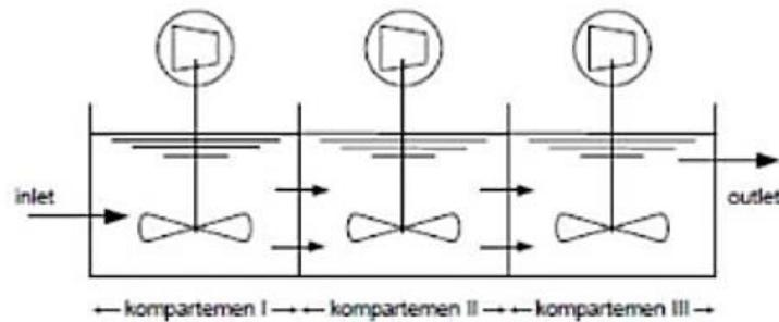
**Gambar 2.17** Pengadukan Lambat secara Mekanis
