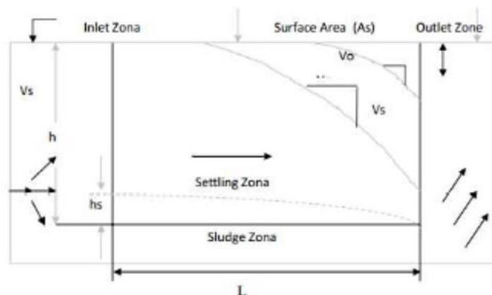
**Gambar 2.19** Zona pada Bak Sedimentasi
