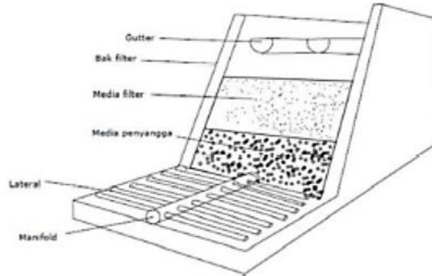
**Gambar 2.23** Struktur Filter Pasir Cepat
