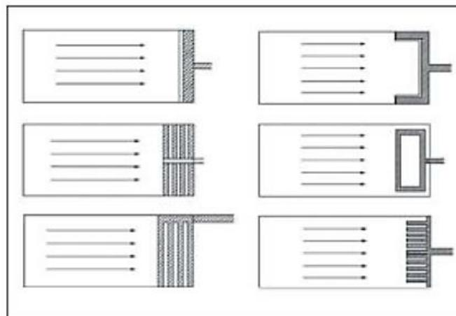
**Gambar 2.5** Beragam Susunan Pelimpah pada Outlet
