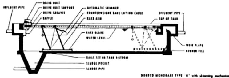
Gambar 2.9 Sketsa Peralatan Pembersih Lumpur Tipe *Travelling Bridge*
