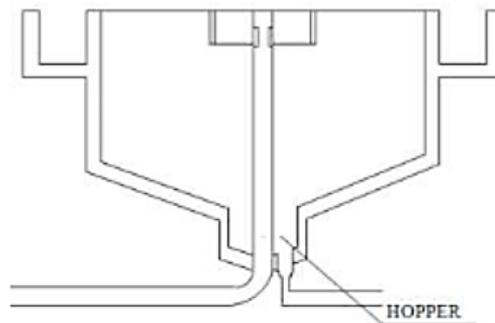
**Gambar 2.11** *Hopper* pada Bak Prasedimentasi Bentuk *Circular*
