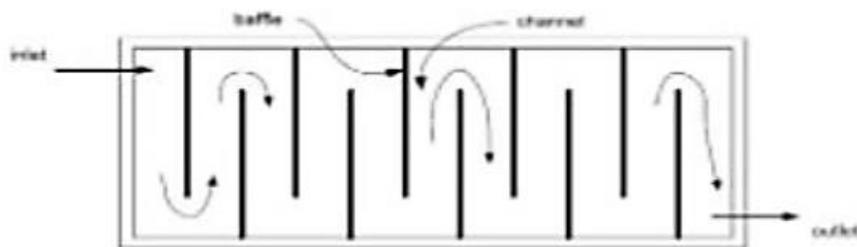
**Gambar 2.18** Pengadukan Lambat secara Hidraulis
