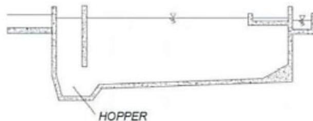
**Gambar 2.7** Hopper pada Bak Prasedimentasi Bentuk *Rectangular*
