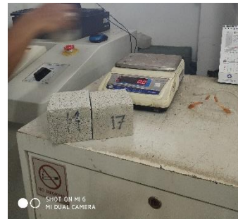
Proses penimbangan Beton ringan
