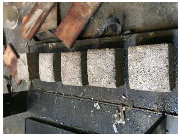
Proses pelepasan Beton ringan Yang sudah dari Cetakan
