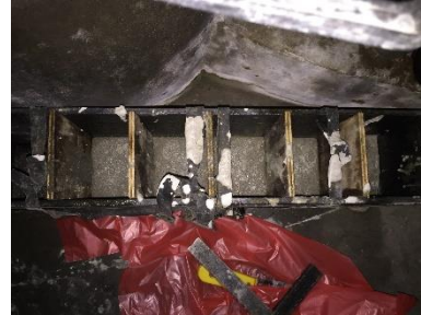
Proses memasukkan adonan ke cetakan
