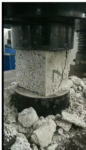
Proses Uji kuat tekan Beton ringan
