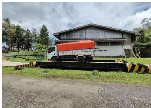
Gambar 8. Jembatan Timbang Sumber: Dokumentasi Pribadi (2022)
