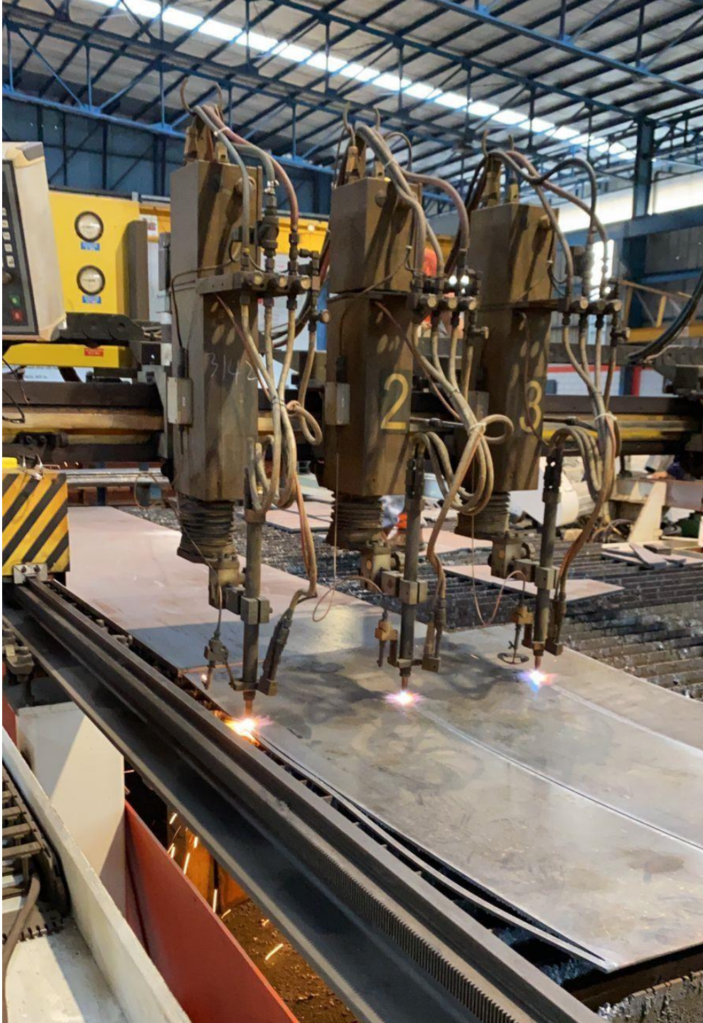
Proses cutting menggunakan mesin cnc
