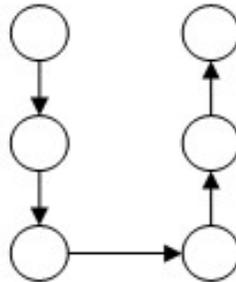
Gambar 2.8 Pola Aliran Bahan U-Shape
