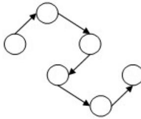
Gambar 2.10 Pola Aliran Bahan *Odd-Angle*
