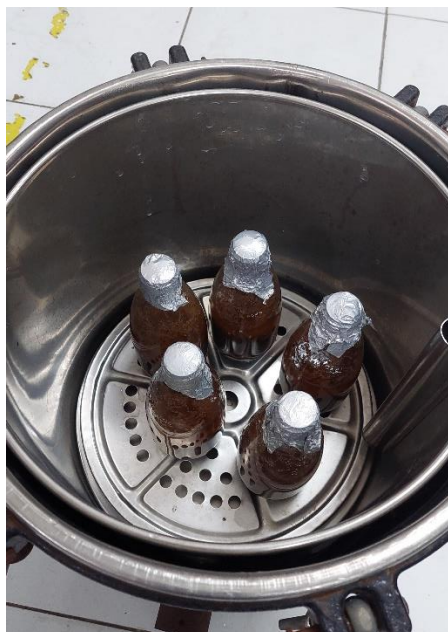
Gambar 3. Pemanasan kedalam autoclave hingga tergelatinasi
