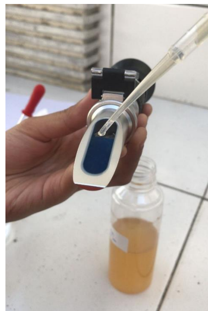
Gambar 8. Proses pengecekan kadar gula dengan refractometer brix
