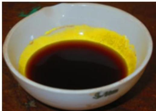
Gambar II. 1 Limbah Elektroplating
