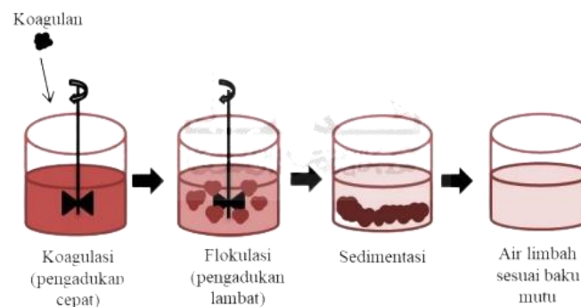
Gambar 2. 1 Mekanisme proses koagulasi flokulasi
