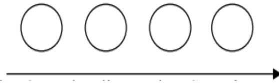
Gambar 2.6 Pola Aliran Bahan Straight Line Sumber: Wignjosoebroto, 2009
