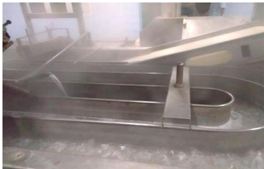
Gambar 9. Proses Perebusan Ikan Teri Nasi Dengan Mesin Sumber : Dokumentasi Pribadi (2019)
