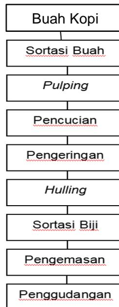
**Gambar 6.** Diagram Alir Pengolahan Basah (*wet process*)
