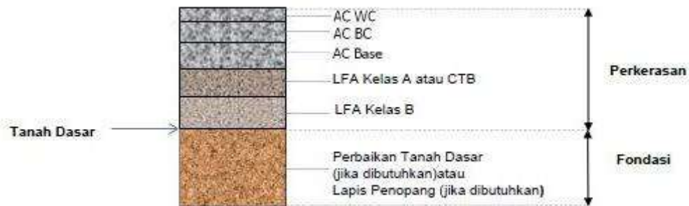
Gambar 2.1 Lapisan Perkerasan Lentur
