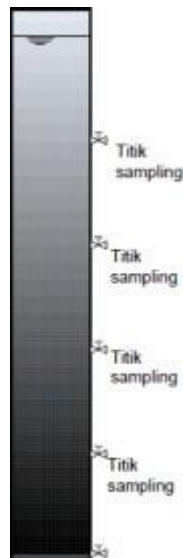
GAMBAR 2. 15 KOLOM TEST SEDIMENTASI TIPE II
