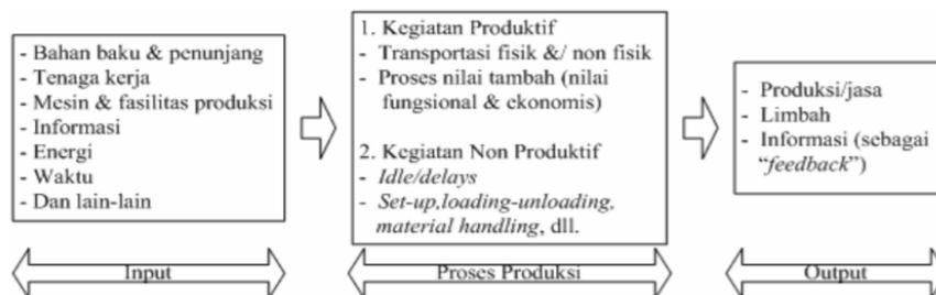
Gambar 2.2 Bagan *input-output* dalam sebuah proses produksi
