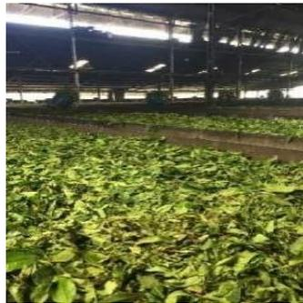
**Gambar 8.** Pembeberan Pucuk Teh Pada *Withering Through*
