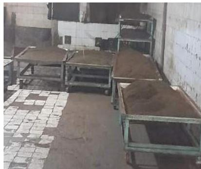
**Gambar 10.** Proses Oksidasi Enzimatis
