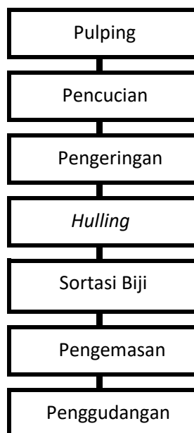
Gambar 5. Diagram Alir Pengolahan Basah Sumber: Mulato (2012).
