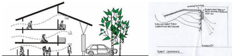
**Gambar 5. 17** Penghawaan Alami (Kiri) Penghawaan (Buatan)
