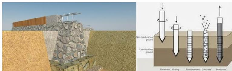
**Gambar 5. 14** Pondasi Batu Kali (Kiri), Pondasi Strous Pile (kanan)
