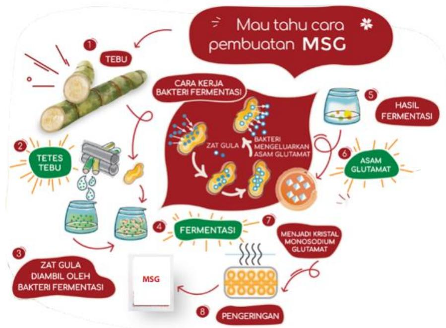
Gambar 2.4 Proses Produksi MSG
