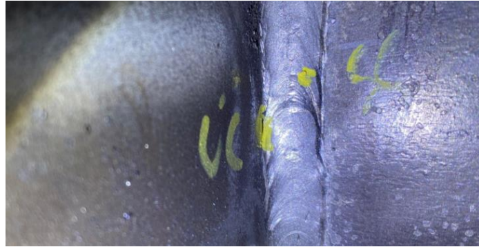
Gambar 2.6 Cacat Pengelasan Undercut (Cerukan)
