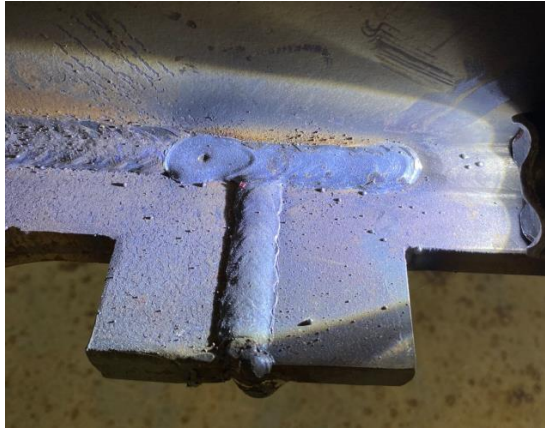
Gambar 2.8 Cacat Pengelasan unequal leg length (panjang kaki las tidak sama)
