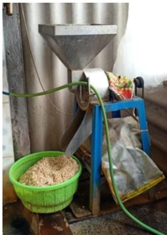
Gambar 6 Mesin Penggilingan Kedelai
