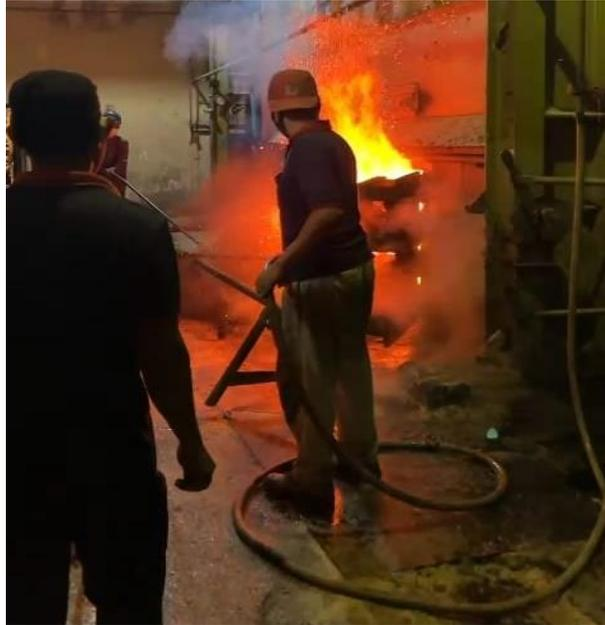
Gambar 1.1 Proses Penggarukan Abu Pada Tungku Pembakaran Ketel
