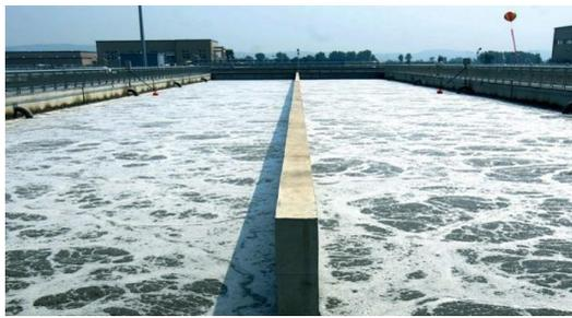
Gambar 2. 18 Lumpur Aktif Dengan Sistem Contact Stabilization
