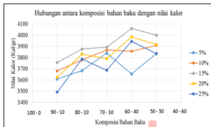
Gambar 5. Hubungan antara variasi komposisi bahan baku blotong dan pelepah pisang terhadap nilai kalor
