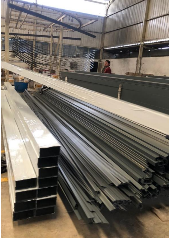
Lampiran 11 : Alumunium Setelah Di Powder Coating
