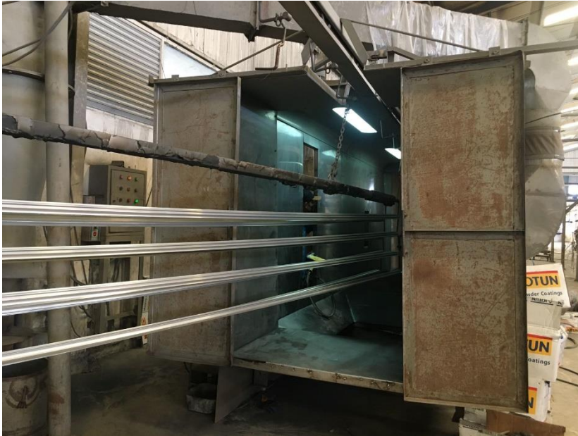
Lampiran 12 : Pengecatan Alumunium
