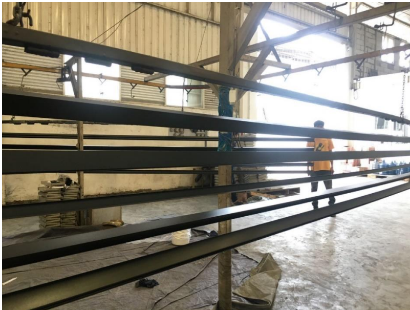
Lampiran 11 : Alumunium Setelah Di Powder Coating
