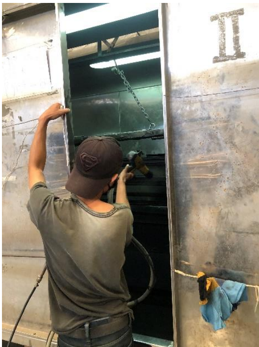
Lampiran 7 : Proses Pewarnaan Alumunium
