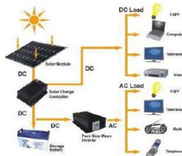
Gambar 5. 17 Konsep Instalasi Panel Surya Sumber (Google.com)
