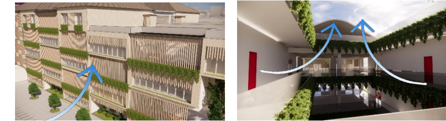
Gambar 6. 13 Aplikasi Sistem Pengudaraan Alami pada Fasad Sumber : Ilustrasi Penulis (2023)
