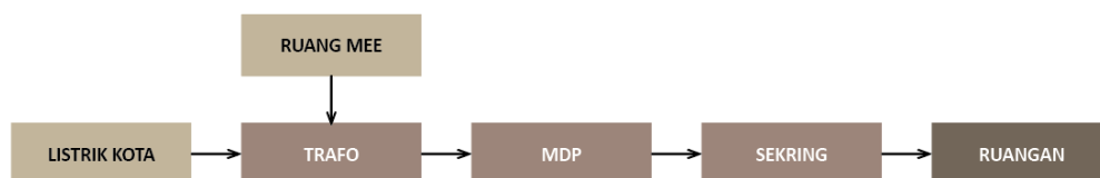
Gambar 5. 29 Skema Jaringan Listrik Sumber: Ilustrasi Penulis (2022)
