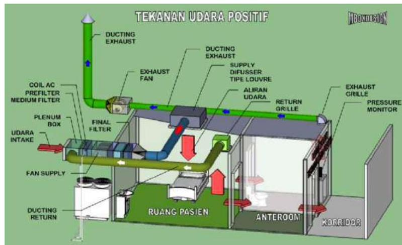
Gambar 6.19. Sistem Udara
