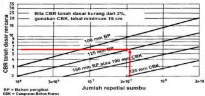
Gambar 4.3 Tebal pondasi bawah minimum untuk perkerasan beton semen
