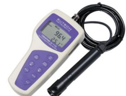
Gambar 3.1 Alat mengukur kadar oksigen terlarut DO meter
