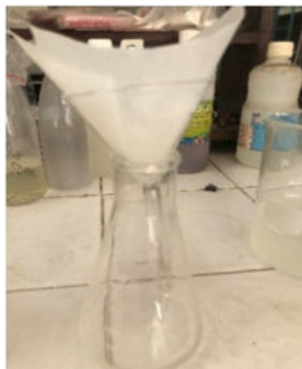
Gambar 3. Proses Penyaringan dengan kertas saring 10x10 cm
