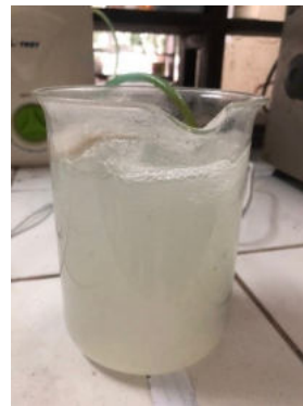
Gambar 2. Proses Ozonisasi Air Limbah Pencucian Beras
