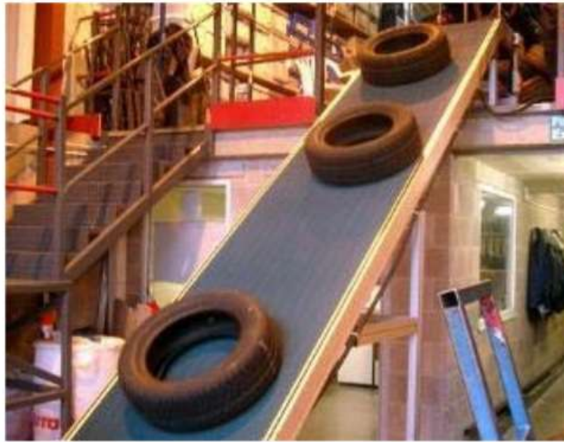
Gambar 2.23. Bentuk Karet belt conveyor.
