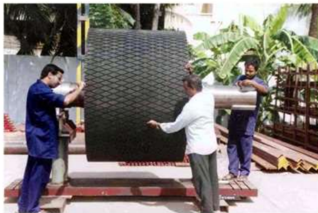
Gambar 2.16. Penservisan Motor dan Pulley.
