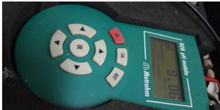
Gambar 2. Pengerjaan analisa sampel Parameter PH yang dilakukan secara langsung pada saat pengambilan di API dan CPI
