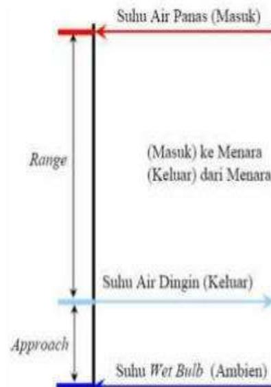
Gambar 2. 10 *Range dan Approach Temperatur pada Cooling Tower*
