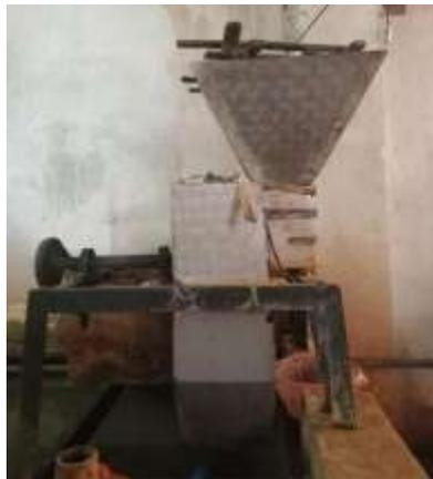
Gambar 7. Mesin Penggilingan Kedelai
