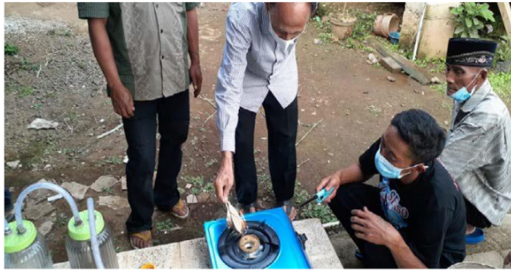
Gambar 3.3. Kompor nyala setelah melalui pemurni biogas
