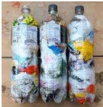
Gambar 14. Botol ecobrick yang sudah siap dirangkai
