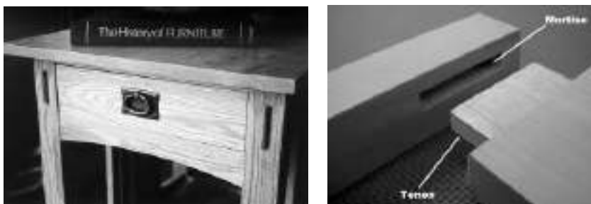
Gambar 2.2. sambungan Mortise dan Tenon Sumber : aronson, 1965
