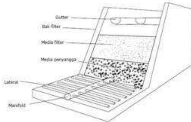
**Gambar 2.7** Detail Bagian Unit Filtrasi
